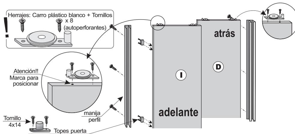
**13-** Seleccionar los herrajes de las PUERTAS correspondientes a la parte inferior y proceder a colocarlos. Antes de atornillar las ruedas inferiores en las PUERTAS, presionar la rueda hacia arriba y colocar la traba plástica roja de la izquierda en posición ON, tal como lo indica el dibujo.
