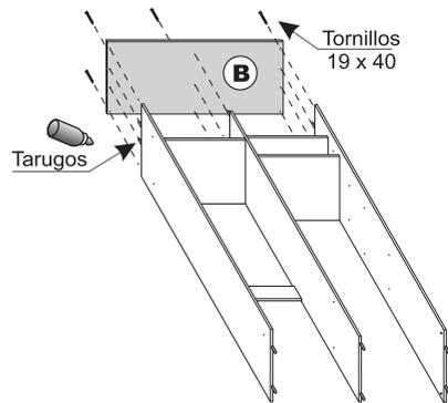
**6-** Colocar cajas y tarugos en las perforaciones de los COSTADOS (8) y (9) y la DIVISIÓN (6). Colocar pernos en el PISO (3). Unir mediante sistema de unión minifix los COSTADOS y con tornillo 19x40 la DIVISIÓN.
